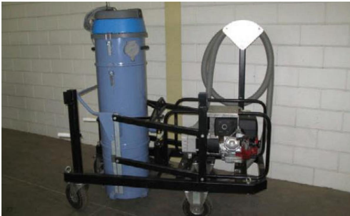
*Handliche kleine Saugereinheit für schwieriges Gelände oder zum Einsatz auf einer Hebebühne. (Bild: NVWA)*
